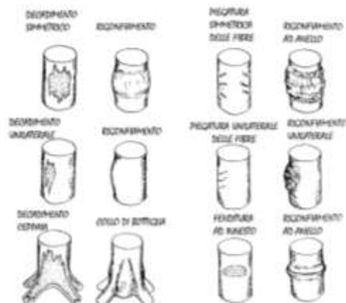
Figura 1. Esempi di anomalie strutturali secondo Mattheck
