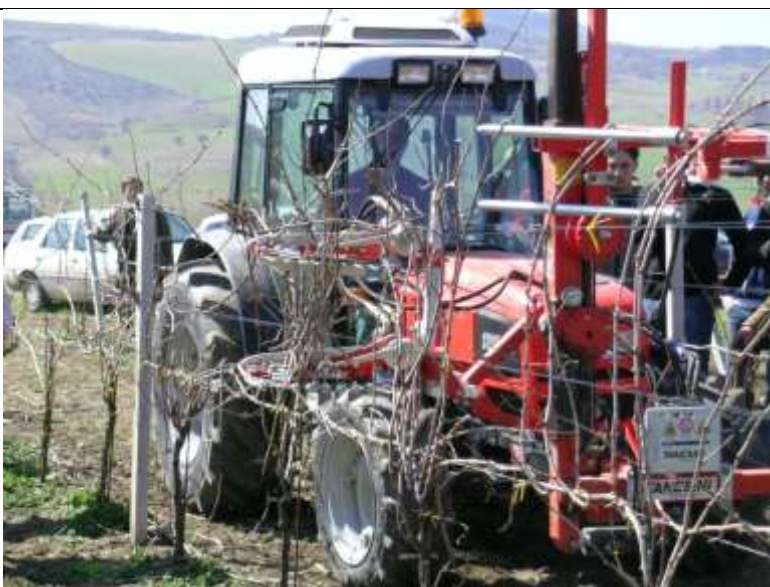
Figura 5. Potatura meccanica di un cordone speronato della vite. Dopo il passaggio della macchina e' consigliabile rifinire la potatura in manuale sia per regolare il numero di nodi per sperone sia per eliminare eventuali succhioni o polloni.
